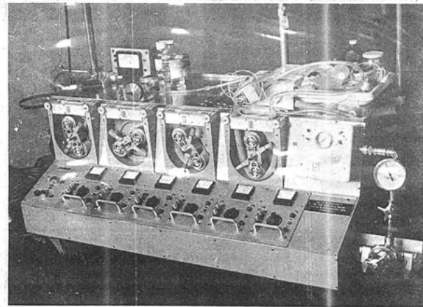
● BOMBA DE circulación extracorpórea, llamada en términos populares "bomba pulmón-corazón", que llega a detener el corazón mismo, para que el cardiocirujano pueda abrir el órgano y de esta forma corregir.
